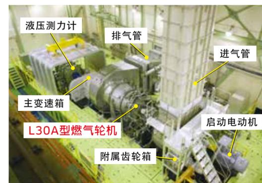
液压测力计 排气管 进气管 主变速箱 启动电动机 附属齿轮箱
