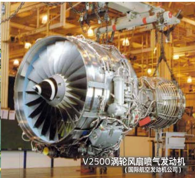
V2500 涡轮风扇喷气发动机
