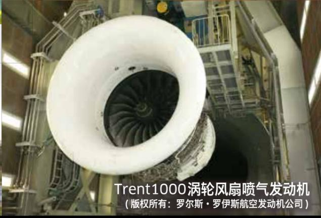
Trent 1000 涡轮风扇喷气发动机
