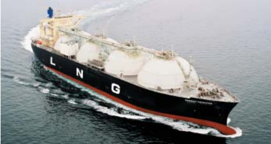
Energy Frontier, a 145,000 m 3 -class LNG carrier
